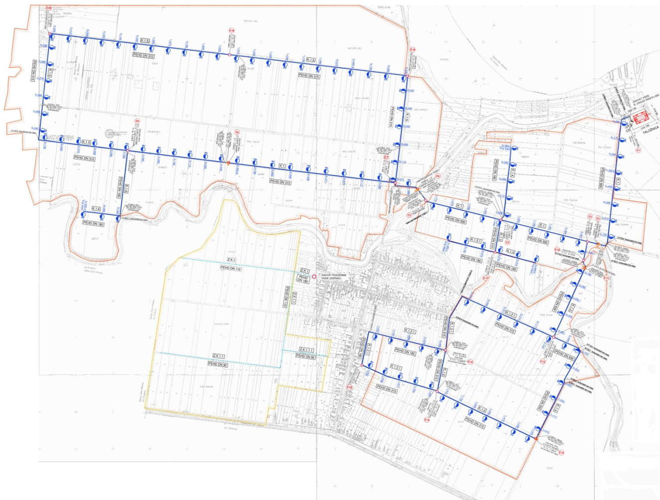
Slika 53. Shema navodnjavanja iz vodozahvata rijeke Drave
